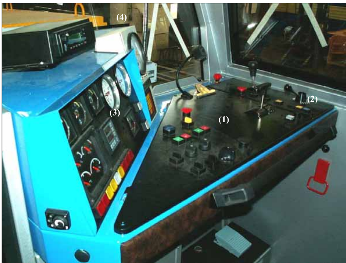
Kompletan izgled prvog upravljačkog pulta mašinovodje, koji je podeljen u sledeće celine: panel upravljača čelni (1) i bočni (2), panel praćenja (3) i brzinomer (4)
