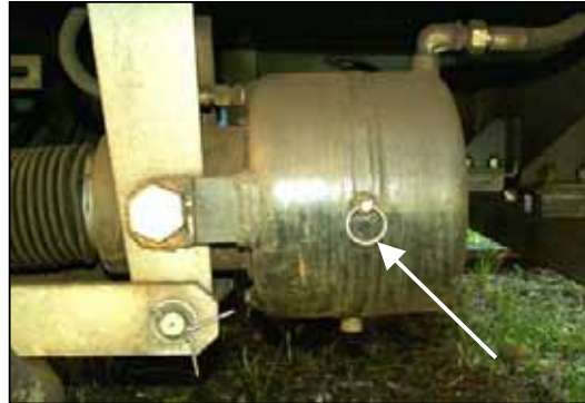
Štednikov kočioni cilindar sa aretacionim čepom za prinudno otkočenje
