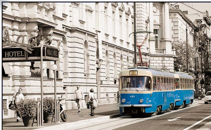
• Tramvaj češke proizvodnje "ČKD-Tatra" T-4+B-4 (tip 401), snimljen na Zrinjevcu, zagrebačkim ulicama vozi od 1977. g. •
