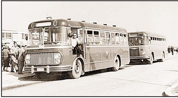
• U prvom je planu autobus FAP 5 GVF-GR, karoserista "11. oktovri" iz Skopja, proizveden 1957., motora snage 130 KS i kapaciteta 3+15+65 mjesta. U voznom parku ZET-a bilo je 10 tih plavih autobusa s tamnoplavim krovom, a otpisani su potkraj 1964., odnosno dio je prodan u Karlovac •
