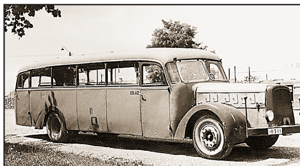
• Od jeseni 1941. zagrebačkim je ulicama vozio "Magirus" 516, garažnog broja 11, a u prometu je bio do kraja 1957. g. Snaga motora 125 KS, kapacitet 32+28 mjesta, godina proizvodnje 1940., karoserist "Avtomontaža" Ljubljana •
