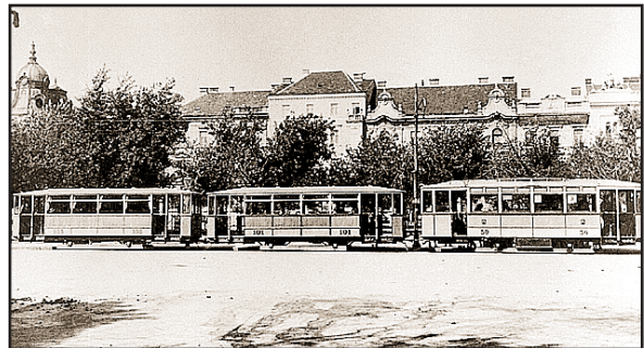
• Vlak s dvjema otvorenim (neostakljenim) Mandlovim prikolicama na Starčeviću trgu pred Glavnim kolodvorom 1924. godine. Poslije su zauzimanjem ravnatelja Košaka uklonjene bočne oplata i uvedena sjedala s preklopnim naslonom, pa su te prikolice onda u toj izvedbi prozване "Košakove" •
