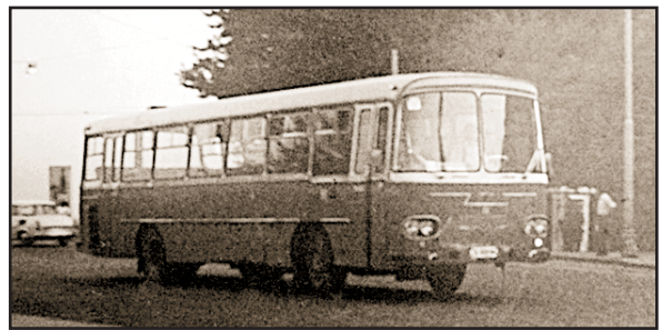
• Na Savskom mostu snimljen je autobus FAP D-13 Dubrava 9 MP. Karoserija ovog autobusa je zagrebačka, a svih 20 vozila zbog loših motora bilo je kratkog vijeka - do 100 tisuća kilometara. Nabavljeni su 1967., bili su međugradski s motorom od 130 KS i 44+36 mjesta. Pojačanim provrtom cilindra (+2 mm) snaga je povećana na 145 KS. Rashod je obavljen između 1970. i 1972. g. •
