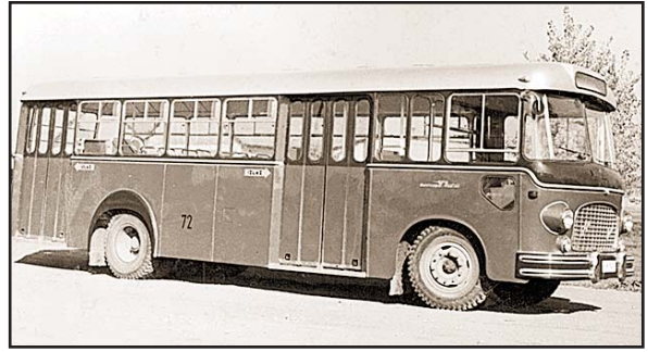
• Karoserist "Ikarus" iz Zemuna sastavio je ovaj FAP 5 GVF-UG 1957. g., snaga motora 130 KS, kapaciteta 2+18+60 mjesta. U tri serije stiglo je devet vozila. Otpis je obavljen 1963./64. g. G.B. 72-80 •
