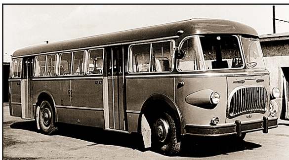
• Škoda 706 RO, karoserist skopski "11. oktombri", u ZET-u od 1956. do otpisa 1961./64. Snaga motora 135 KS, kapacitet 3+22+55 mjesta, G.B. 52-57. Autobusi su u Zagreb došli bez sjedala pa su ona naknadno ugrađena u "Autodubravi". Vozila su bila plava s tamnoplavim krovom, a otpisana su 1961./64., a dva (i ovaj sa slike) prodana su u Prijedor •
