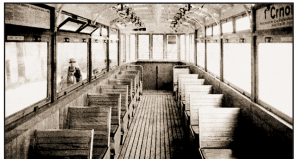
• Unutrašnjost zatvorene "Košakove prikolice". Preklopivi nasloni na sjedalima omogućuju po želji i nasuprotno sjedenje, a ogibeljni viseći rukohvati ne sukobljavaju se više sa šesirima. Poslije su se počeli zatvarati otvoreni peroni i ostalih tramvajskih vozila •
