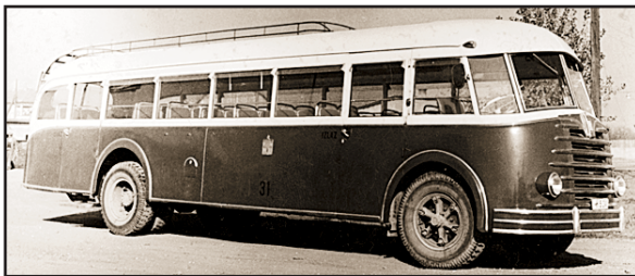
• ZET je u jesen 1950. kupio izložbeni primjerak sa Zagrebačkog velesajma, autobus "Fiat" 680 RN. Ukupno 55 sjedacih mjesta bilo je u tom vozilu garažnog broja 31, sa snagom motora od 123 KS. Na vozilu su bile penjalice za krov gdje je bio prostor za prtljagu putnika. Generalka je obavljena u "Autoremontu" u Dubravi 1959. g., a odmah potom autobus je vozio na izlet trasom Zagreb-Bled-Rijeka-Plitvička jezera-Zagreb. U ZET-u je vozio do 1963., a nakon toga promijenio je dva vlasnika do otpisa 1972. g. •
