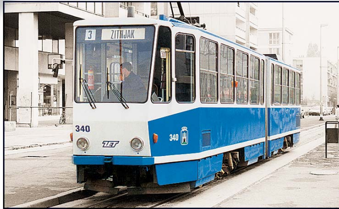
• Zglobni češki tramvaj KT-4, popularna "katica" snimljena na stajalištu na Ljubljani. Od 1985. nabavljeno je 50 takvih četveroosovinskih zglobnih tramvajskih motornih kola •
