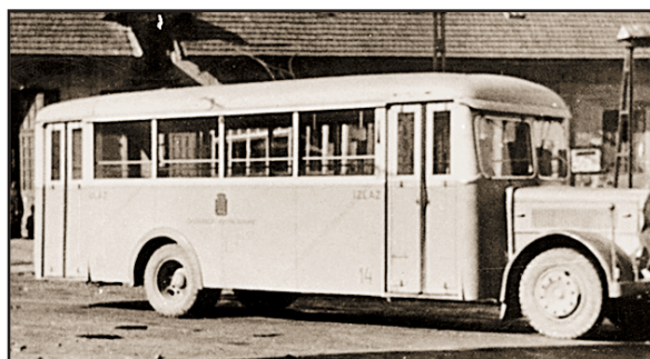
• Prva dva MAN-a, tip L 1, došla su u ZET 1941. godine, a vozili su do 1957. Kapacitet 17+23 mjesta, snaga motora 100 KS, GB 14 i 15. Prema dostupnim podacima, nacрте za vozila izradio je ZET, a je li ih i sagradio, nije poznato. Postoji samo podatak da su napravljeni u Zagrebu. U vrijeme NDH autobusi su na sredini karoserije imali grb grada, a ispod njega natpis Zagrebački autobusni promet •
