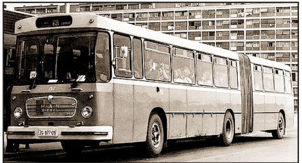
• Prvi zglobni autobusi stigli su u ZET 1969. godine. Na slici je MAN 890 UG M 16 A, snimljen na stajalištu u Zaprudu. Kapacitet vozila je 160 putnika, duljina 16,5 m, snaga 144 kW, pogonska osovina srednja •
