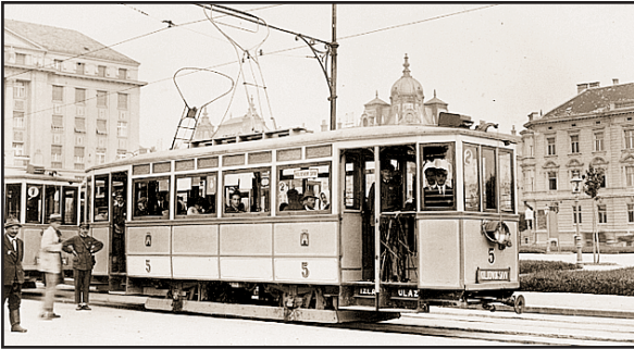
• Motorna kola M-22 (iz 1922.), prva tramvajska kola (još s drvenim kosturom), što ih je konstruirao inženjer Mandl, a proizvedena su u ZET-ovim radionicama. Prizor je snimljen na bivšem terminalu kod hotela "Esplanade" •
