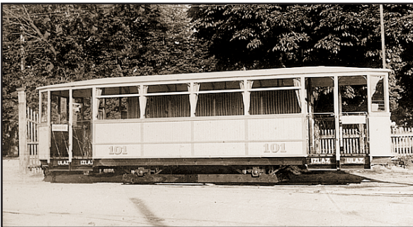
• Prva Mandlova (ljetna) prikolica iz 1924. s neostakljenim bočnim stijenama. Ova je prikolica tridesetih godina adaptirana u atraktivnije vozilo, uz sudjelovanje ravnatelja Košaka, pa je taj tip kola onda u ZET-u prozvan "Košakovom prikolicom". Slika je snimljena u dvorištu starog spremišta •
