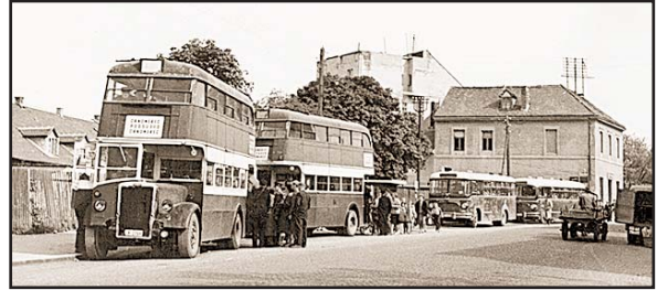
• Iz Londona ZET je 1955. i 1956. g. nabavio četiri rabljena katna autobusa "Leyland" PD-1, proizvedena 1946. g., duga 9 m, visoka 4,5 m i široka 2,5 m. Pogonjeni su motorom snage 127 KS, kapaciteta 56+14 mjesta. Autobusi GB 61-64 kupljeni su navodno u zelenoj boji s prijedjenih milijun kilometara, a tijekom pet godina vožnje u Zagrebu na liniji Črnomerec-Podsused prešli su još 300 tisuća kilometara. U Zagrebu su vozili do 1960., kada su prodani u Sarajevo •
