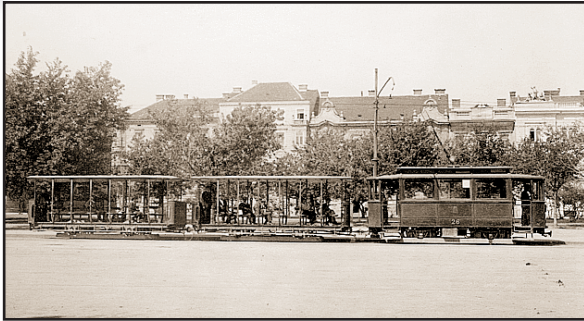
• Ganzova motorna kola iz 1910. s dvjema Eisenhutovim prikolicama snimljena na Glavnom kolodvoru •
