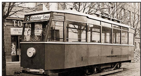
• Pokusna jednosmjerna tramvajska motorna kola izvedena u ZET-u 1942. pregradnjom Mandlovih kola M-24 snimljena za Drugoga svjetskog rata na bivšoj pruzi u Heinzelojvoj ulici •
