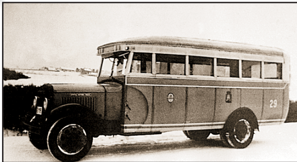
• Autobus "Buick", proizvođača "General Motors", tip GMC-T 30, sa 18 sjedala smještenih u smjeru vožnje •
