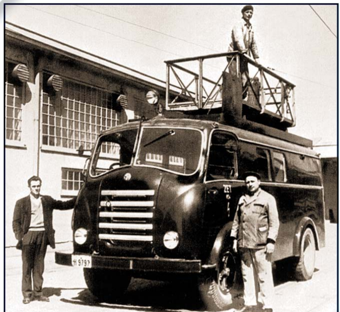
• Prva ZET-ova montažna kola gornjeg voda na motorni pogon - "Alfa-Romeo" iz 1945. godine •
