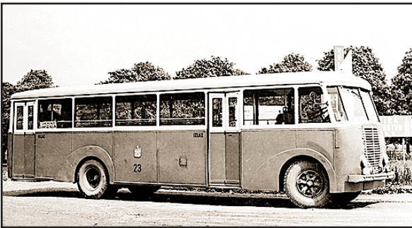
• Autobusi marke "Lancia" 3 RO, GB 23 i 24, u prometu su bili od travnja 1948. do prosinca 1960., kada su prodani u Viroviticu. Vozila kapaciteta 27+31 mjesto konstruirani su u radionicama ZET-a gdje je obavljena dogradnja na podvozjima "Lancia" iz 1944. g., a koja su u ZET stigla potkraj 1946. g. Motor se pokretao "kurbloom", a nakon generalke ugrađen je elektropokretač snage 6 KS •
