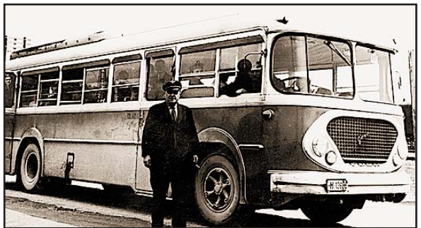
• "Alfa-Romeo" 910 AUS (ukavejka), karoserist "Goša" Smederevska Palanka, godina proizvodnje 1958., snaga motora 130 KS, kapacitet 40+20 mjesta, G.B. 66, 67 i 68. Autobus je imao tapecirana sjedala, uglavnom je vozio na liniji Zagreb-Samobor te na izletničkim vožnjama. Tim su autobusima iz Smederevske Palanke tegljene autobusne prikolice. Otpisani su 1964. g., a broj 68 prodan je u Karlovac •
