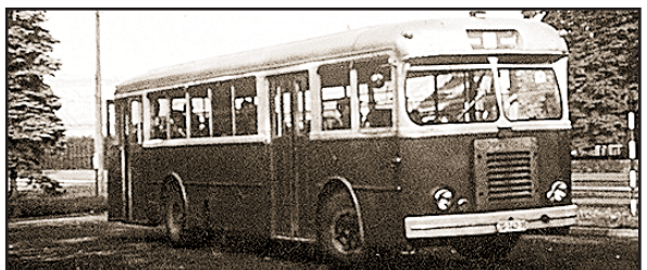
• "Alfa-Romeo" 1000 AU (Alfa-Milla) proizveden 1961. i 1962. u "Goši", snage motora 163 KS, kapaciteta 2+21+84 mjesta. Nabavljeno je 35 autobusa, a svi su osposobljeni za vuču prikolice. Otpisani su 1969. i 1970., osim broja 216, koji je ostao za tegljenje pokvarenih vozila u garaži Dubrava do 1976. g. Šest autobusa nakon otpisa poslano je u Banju Luku za smještaj stanovnika - stradalnika potresa •
